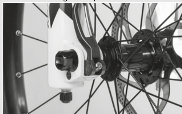
Illustration 42 : Position parfaite du levier de serrage
