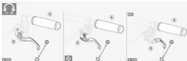
Illustration 62 : Régler la garde d'un levier de frein à disque Magura
