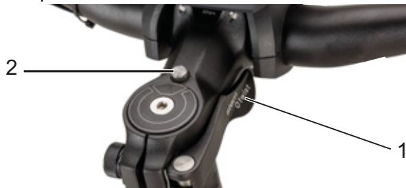
Illustration 82 : Potence, modèle II avec levier de serrage de l'attache rapide de la potence (1) et bouton de déblocage (2)
