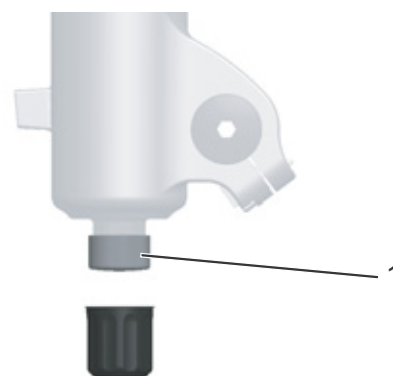
Illustration 67 : Dispositif de réglage de la détente FOX (1) sur l'extrémité de fourche
