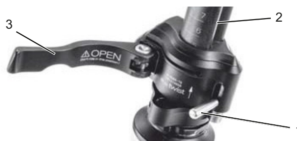
Illustration 81 : Levier de serrage ouvert de l'attache rapide de la potence (3) sur la potence (2), modèle I, avec levier de blocage sur la potence (1)
