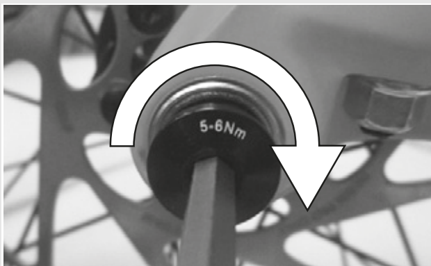
Illustration 35 : Serrer la vis de blocage
