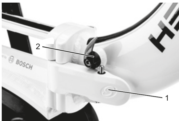
Illustration 83 : Levier de blocage du cadre fermé (1) et ouvert (2)
