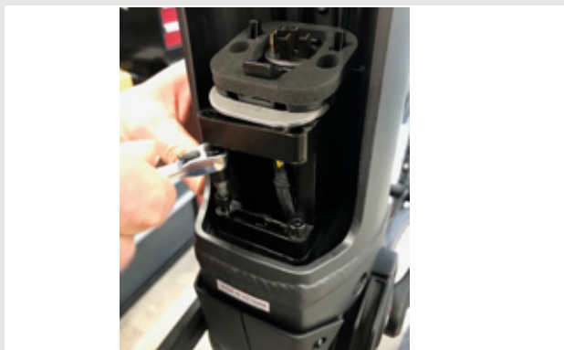
Illustration 27 : Retirer les vis à 6 pans de 4 mm
