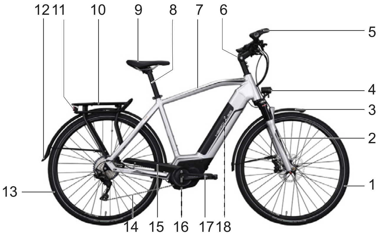
Illustration 2 : Vélo électrique vu de droite, exemple d'un HERCULES Futura Pro 1
