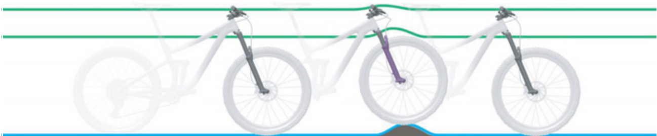
Afbeelding 10: Optimaal rijgedrag van de vork bij oneffenheden
