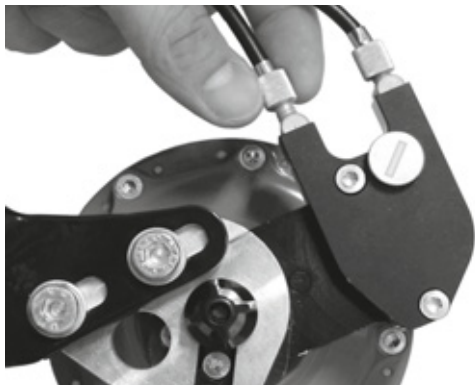
Afbeelding 144: Bij Rohloff naafversies met externe schakelaansturing zit de kabelafsteller op de kabelbox aan de linkerzijde
