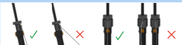
Afbeelding 178: Correcte en verkeerde bowdenkabel
