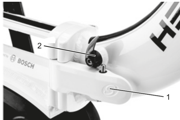
Rysunek 43: Otwarta (1) i zamknięta (2) dźwignia zabezpieczająca ramy
