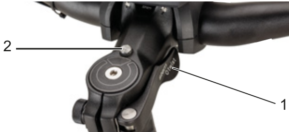
Rysunek 42: Mostek, wersja II z dźwignią mocującą zacisku szybko mocującego (1) mostka i przyciskiem odblokowującym (2)
