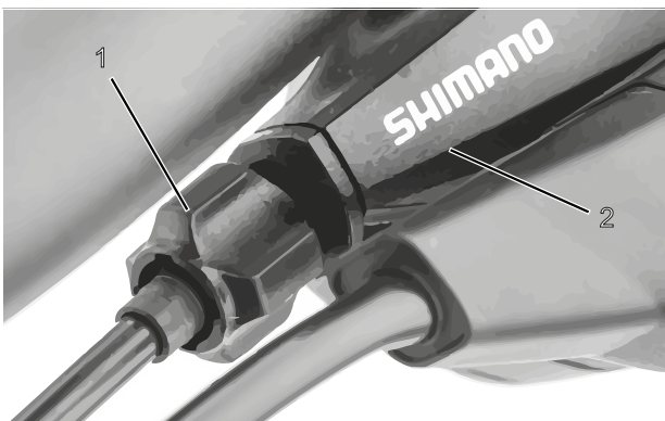
Rysunek 50: Nakrętka regulacyjna (1) jednocięgnowego mechanizmu zmiany przerzutek z obudową dźwigni zmiany biegów (2), przykład
