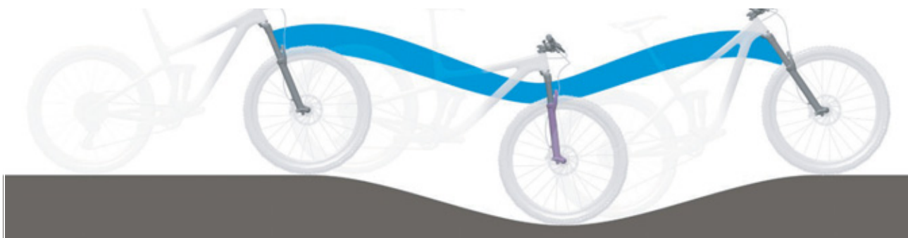
Rysunek 6: Optymalne działanie widełca na pagórkowatym terenie
