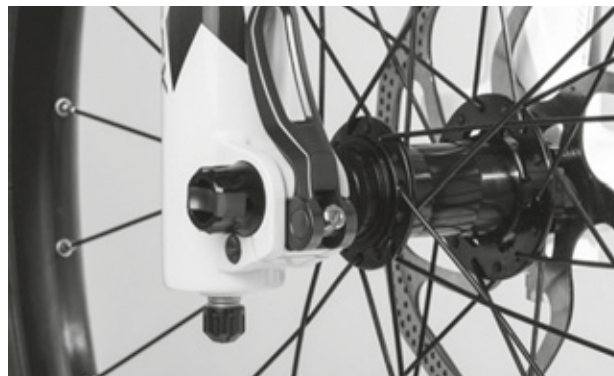
Rysunek 48: Ustawianie siły mocowania zacisku szybko mocującego
