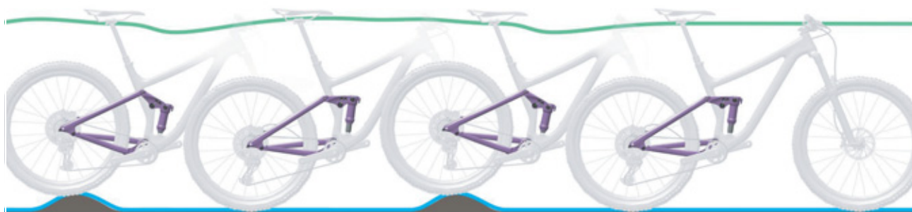
Afbeelding 62: Optimaal rijgedrag van de achterbouwdemper
