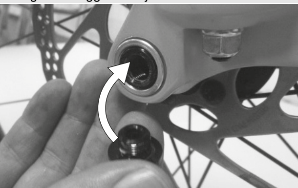
Afbeelding 24: Snelspanhendel in as schuiven
