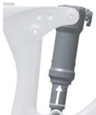
Afbeelding 60: O-ring op de achterbouwdemper verschuiven
