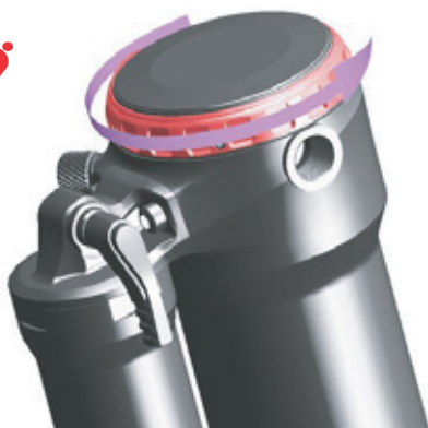
Afbeelding 100: Draai de trekdemperafsteller in de richting van de haas
