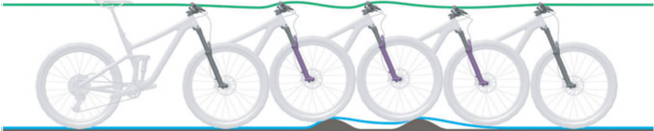
Afbeelding 91: Te langzaam uitveren van de verende voorvork
