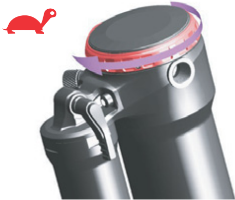
Afbeelding 98: Draai de trekdemperafsteller in de richting van de schildpad
