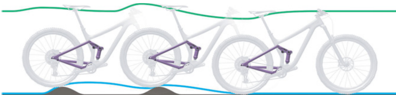
Afbeelding 99: Te langzaam uitveren van de achterbouwdemper
