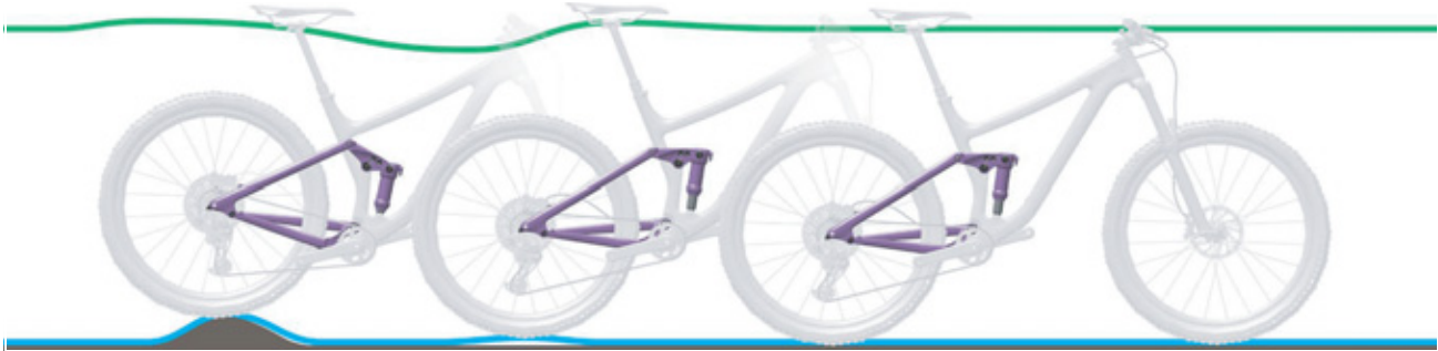
Afbeelding 97: Te snel uitvoeren van de achterbouwdemper
