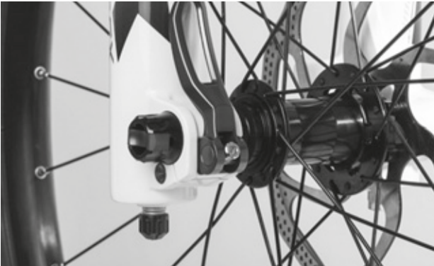
Afbeelding 84: Spankracht van de snelspanner afstellen
