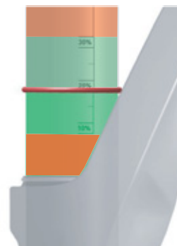
Afbeelding 58: Voorgeschreven sagbereik (groen) en verboden sagbereik
