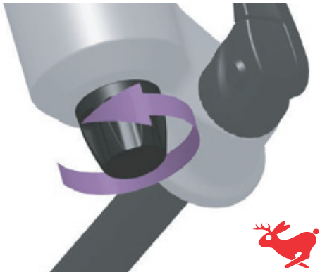
Afbeelding 92: Draai de trekdemperafsteller in de richting van de haas
