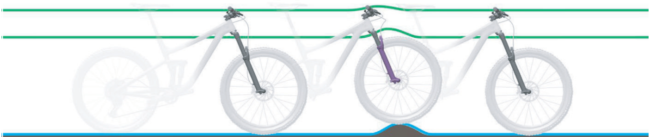
Abbildung 7: Optimales Fahrverhalten der Gabel bei Unebenheiten
