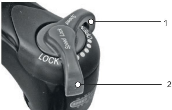
Abbildung 73: Suntour-Druckstufedämpfer in offener (1) und geschlossener (2) Position
