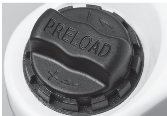
Abbildung 40: Einstellrad SAG auf der Krone der Federgabel
