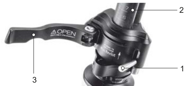
Figura 146: Palanca tensora abierta del cierre rápido de la potencia (3) en la potencia (2), versión I, con palanca de seguridad en la potencia (1)
