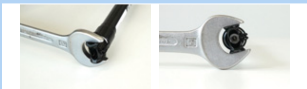
Figura 190: Aseguramiento para evitar el giro
