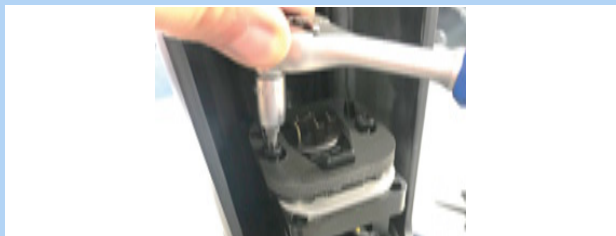
Figura 51: Aflojamiento de los tornillos del soporte del adaptador
