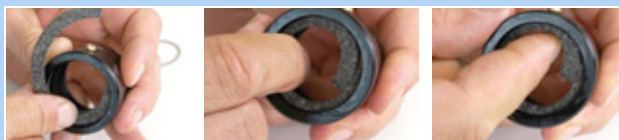
Figura 182: Inserción del anillo de fieltro
