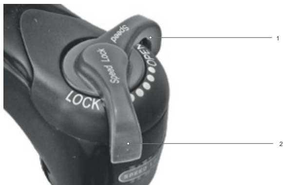
Figura 236: Ajuste para un regulador de niveles de presión más duro
