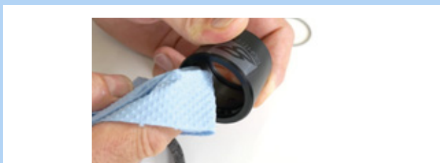
Figura 216: Limpieza del manguito exterior
