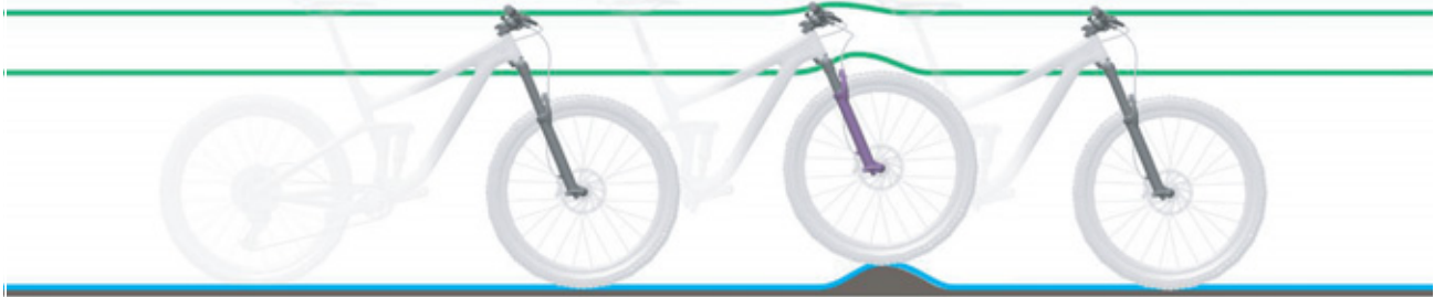
Figura 136: Condición óptima de marcha en terrenos con irregularidades
