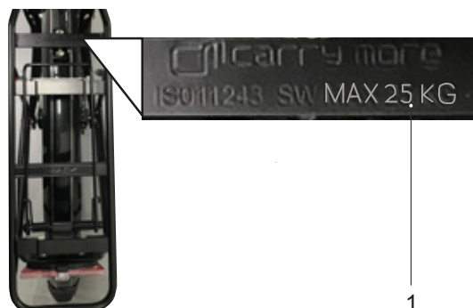
Figura 127: Identificar la capacidad máxima de carga (1) sobre el portaequipajes.
