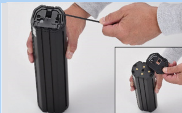
Figura 57: Desmontaje de la interfaz superior
