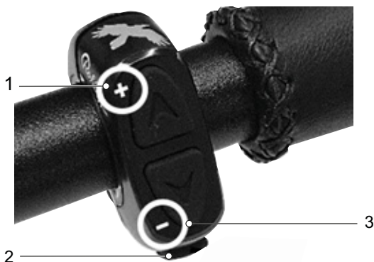
Figura 143: Botones del manillar ROHLOFF E-14
